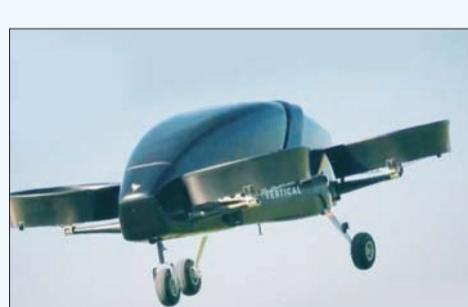
[www.hightech.fm](http://www.hightech.fm) saytının məlumatında bildirilir ki, “Vertical Aerospace” uçuş aparatının maksimal sürəti avtomobil sürətinə uyğundur və saatda 80 km təşkil edir. Aparat 2 nəfər sərnişin və 1 pilot üçün nəzərdə tutulub. Mütəxəssislərin sözlərinə görə, akkumulyatorun enerji tutumu 800 km uçuşun həyata keçirilməsi üçün yeterlidir.
